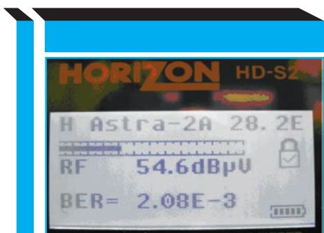
4 Εύρεση δορυφόρου και μέτρηση στάθμης σήματος και BER στο HD-S2.
