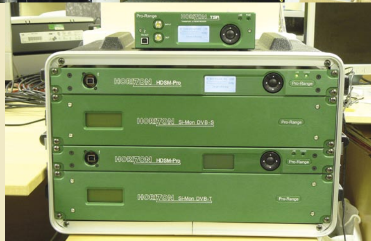
▲ Ściśle tajne! Pierwszy egzemplarz Pro Series dla nadawców, na przykład do sprawdzania jakości sygnału w samochodowych OB. Mała jednostka na górze to Transport Stream Reader – czytnik strumienia danych, odpowiadający specyfikacji Pro Series. Pro Series zostanie wprowadzona w drugim kwartale 2008
