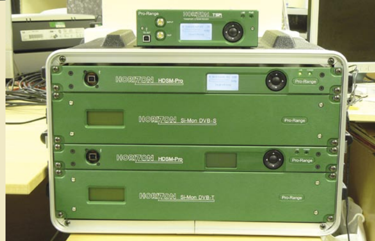
▲ Çok gizli! Yayıncılar için OB Vanlar gibi araçlarda sinyal kalitesini ölçmek için kullanılmak üzere üretilen Pro serisi cihazların ilk numunesi! Üstteki küçük cihaz TSR Transport Stream Reader, aynı şekilde Pro serisi özelliklerini taşıyor. Pro serisi 2008'in ikinci çeyreğinde piyasaya sunulacak.
